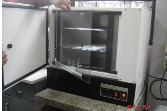
Figura 16. Cámara de curado a vapor generando humedad saturada
