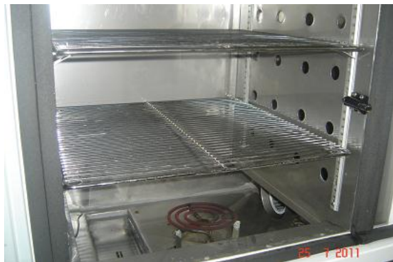
Figura 14. Parte interna de la cámara de curado a vapor, donde se aprecia el sistema de funcionamiento
