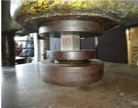
Figura 39. Cubo en la máquina universal durante el ensayo a compresión
