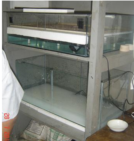
Figura 13. Arriba la cámara de humedad y abajo la cámara de inmersión en funcionamiento desde una vista lateral
