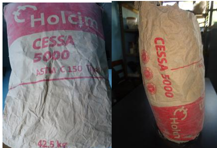
Figura 23. Cemento tipo I (ASTM C 150-11), en vista frontal y lateral
