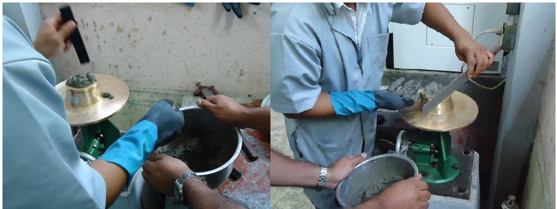
Figura 31. Preparación de la mezcla previo a realizarse el ensayo de flujo
