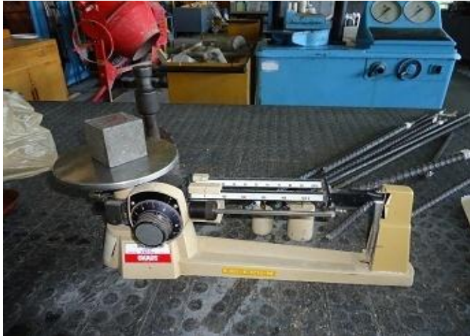
Figura 19. Balanza analítica marca OHAUS, con una capacidad de 2 610 g y una precisión 0,1 g
