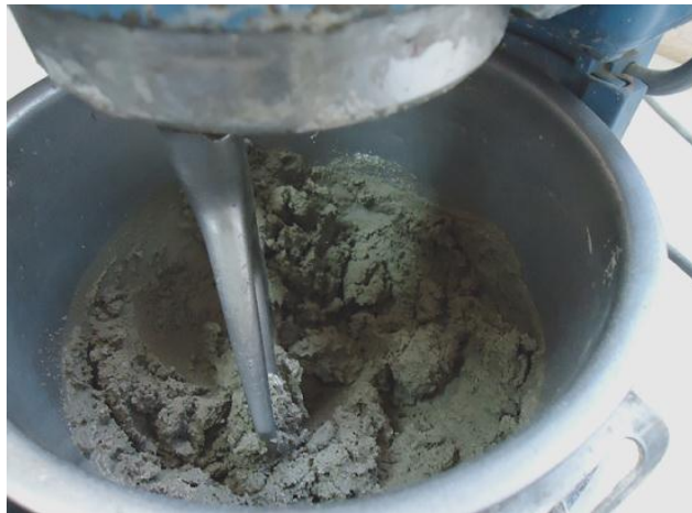
Figura 30. Mezclado final para dar paso al ensayo de flujo
