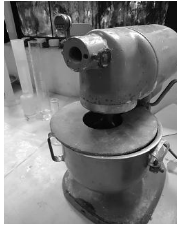
Figura 20. Mezcladora protegida con un molde de madera que evita la evaporación del agua durante el proceso de mezclado
