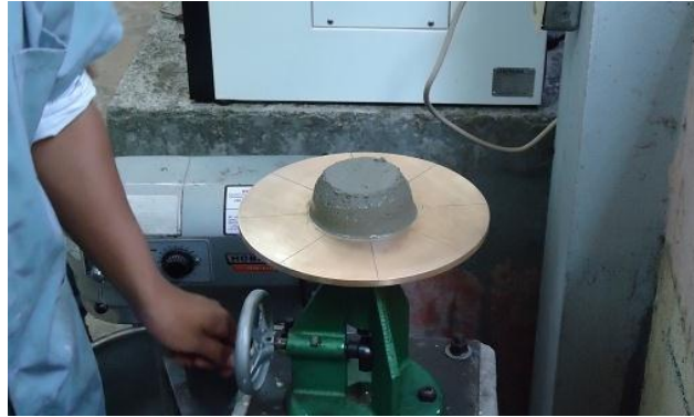
Figura 32. Ensayo de flujo de una muestra combinada con cemento
