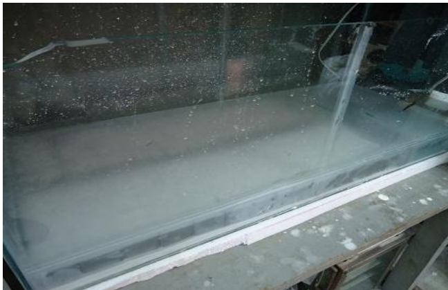
Figura 37. Especímenes almacenados en agua saturada con cal
