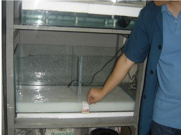
Figura 12. Cámara de inmersión en funcionamiento, saturada con agua y cal, a una altura de 8 cm
