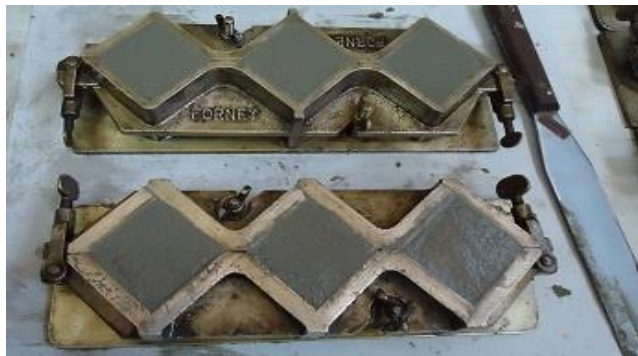
Figura 35. Especímenes preparados para ingresar a la cámara de humedad
