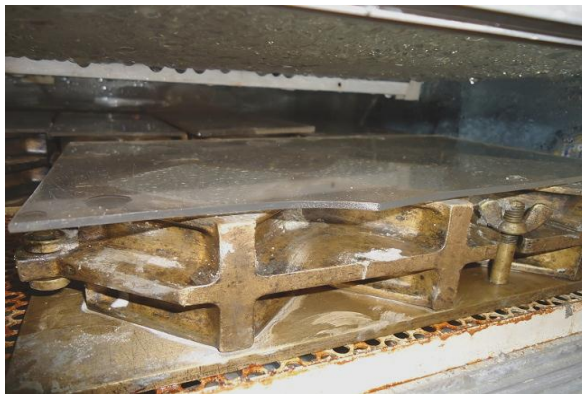
Figura 36. Molde en cámara de humedad, protegido en su superficie contra el goteo por una plancha de plástico
