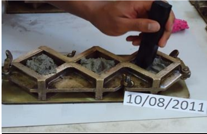
Figura 34. Apisonamiento del material, que consiste en 32 golpes en cada capa para un total de 64
