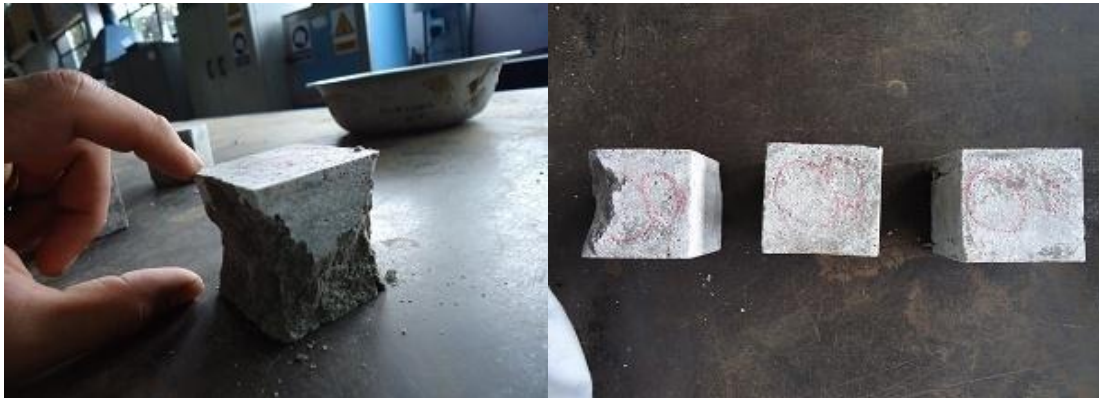
Figura 43. Cubos cemento-puzolana fallados a compresión luego del ensayo
