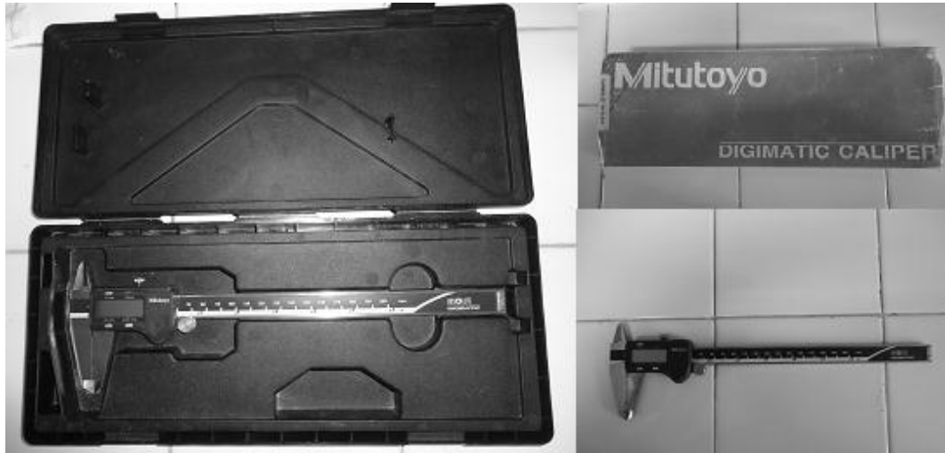
Figura 18. Vernier digital marca Mitutoyo, con una capacidad de 200 mm y una precisión de 0,02 mm
