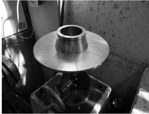
Figura 21. Mesa de flujo según requerimientos de ASTM C 230-08
