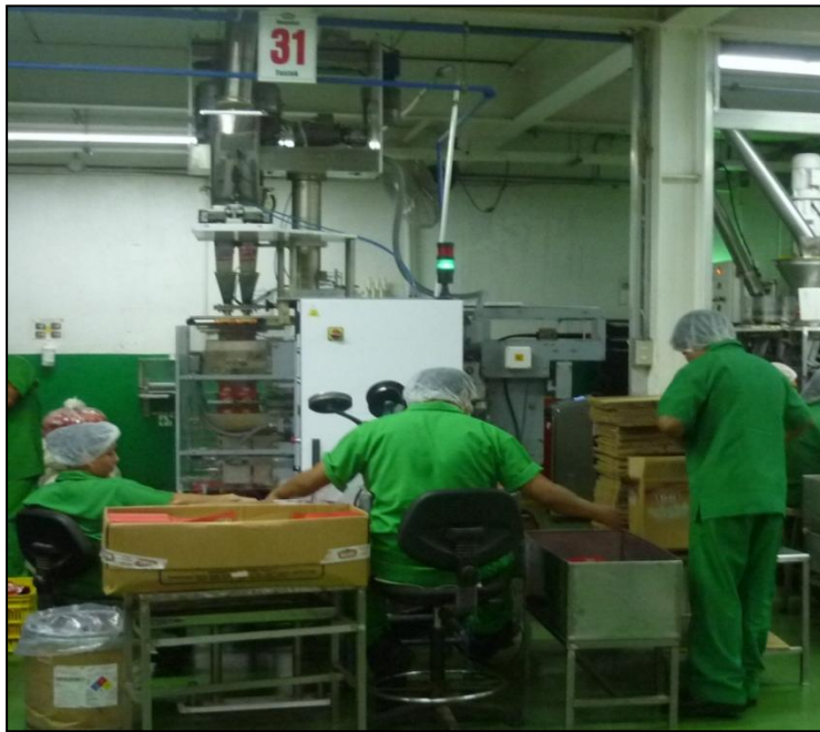
Figura 28. Máquina propuesta para producción de sopas
