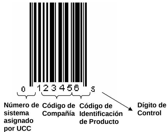
Figura 8. Estructura del código UPC-E
