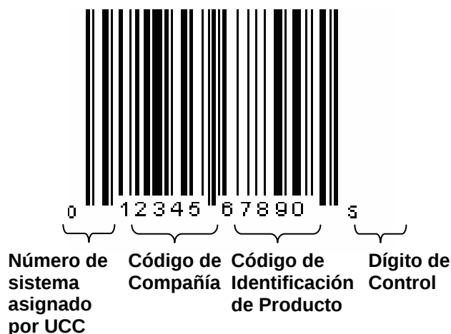
Figura 7. Estructura del código UPC-A
