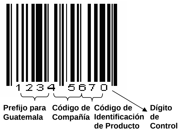
Figura 6. Estructura del código EAN 8
