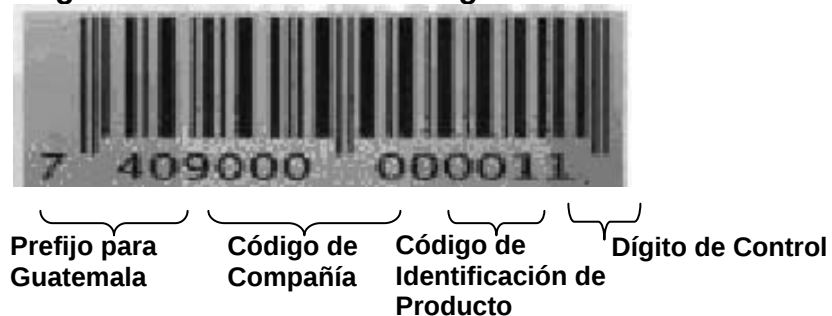
Figura 5. Estructura del código EAN 13
