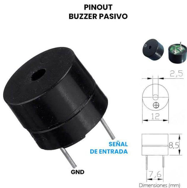
*Nota.* El Buzzer Zumbador Pasivo 5V es un piezoelectrico que se encuentra adherido a un disco cerámico sobre una placa vibrante. La tensión aplicada causa una contracción o expansión del disco cerámico, generando sonidos. Obtenido de Unit Electronics (2025). *Buzzer Zumbador 5V Pasivo.* (<https://uelectronics.com/producto/buzzer-zumbador-5v-pasivo/>), consultado el 28 de mayo de 2025. De dominio público.
